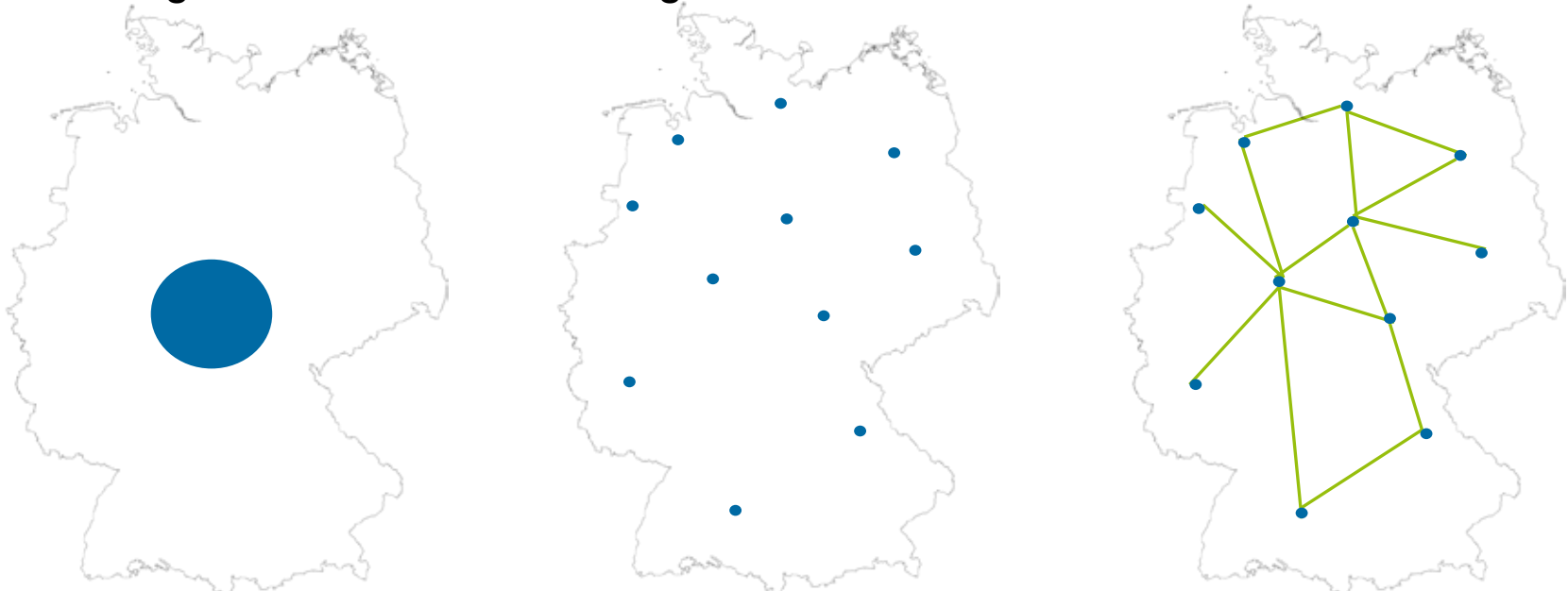
Abb. 6: Modellerweiterung PowerFlex zu PowerFlex Grid: Regionalisierung und Einbindung von Leitungen (Quelle: Öko-Institut e.V.)
